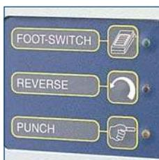
› Le tableau de contrôle centralisé permet la commande de perforation par pédale ou par touche digitale.
