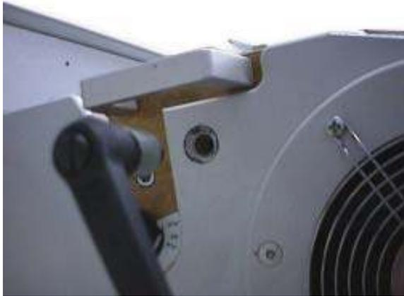
De chaque côté de la machine se trouve une vis de serrage rapide.
