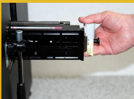
Les blocs-outils sont interchangeables très facilement. Ils coulissent sur des rails ce qui permet un positionnement précis.
