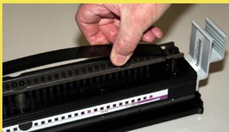
Les blocs-outils sont équipés d'un système de clipsage qui permet en quelques secondes de changer un ou plusieurs poinçons.
