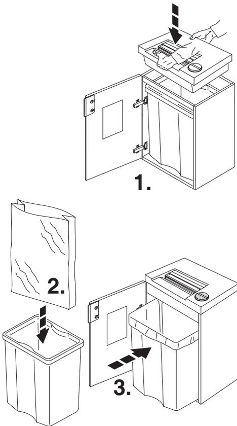
**DE** Türe öffnen, Maschine mit Bedienfeld nach vorne aufsetzen! Auf Finger achten! **Verletzungsgefahr!**
