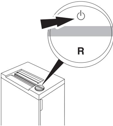
**IT** Standby automatico che si spegne dopo 30 minuti. La macchina può essere spenta in qualunque momento tenendo premuto il pulsante (here the image of the switch) per 2 secondi. Led verde luce di controllo
