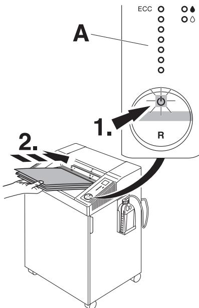
**NL** Schakelaar indrukken (1.) : groen licht gaat aan, machine is bedrijfsklaar. Start automatisch zodra papier wordt ingevoerd. Automatische standby schakelt naar 30 minuten uit. De machine kan op elk gewenst moment worden uitgeschakeld door gedurende 2 seconden op de knop te drukken. Groene LED controlelampje s uit. De machine verbruikt dan geen stroom meer.
