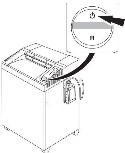
**DE** Autom. Standby - Abschaltung nach 30 Minuten. Maschine kann jederzeit durch 2 sec. langes Drücken des  $\odot$  Schalters ausgeschaltet werden. Grüne Kontrollleuchte  $\odot$  erlischt. Danach verbraucht die Maschine keinen Strom mehr.
