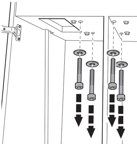
**DE** 4 Innensechskantschrauben M 8 x 50 mit Scheibe entfernen.
