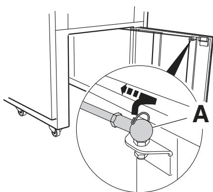
Décrocher, des deux côtés, le ressort des boules (A).
