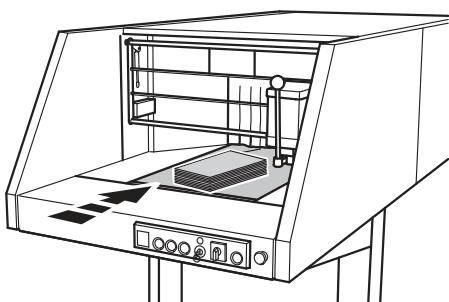
Ce destructeur est doté de la fonction "2 vitesses". Lorsque la machine n'arrive pas à détruire les documents en vitesse rapide, elle bascule automatiquement en vitesse lente, une vitesse dégageant plus de puissance.
