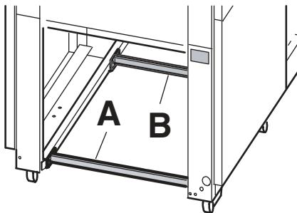
Le transport de la machine n'est possible que dans le sens de la longueur et par l'arrière avec les barres de transport (A) et (B) montées.
