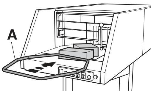
Les éléments à détruire qui ne sont pas entraînés jusqu'au bloc de coupe, ne peuvent être amenés au bloc que grâce au poussoir (A).
