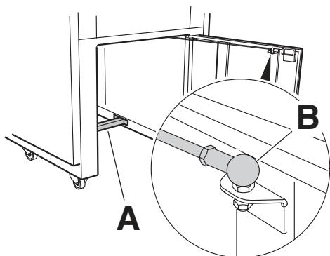
Si la machine doit être utilisée avec un chariot de réception, il faut remonter la barre arrière (A) ainsi que la tige de tension (B).
