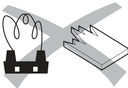
Ne pas détruire des matériaux susceptibles de s'enrouler (ficelles, bandes...) ou de provoquer des éclats.
