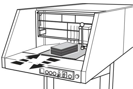
Si le bloc de coupe n'arrive toujours pas à détruire les documents, les cylindres de coupe et la bande tournent un instant dans le sens contraire avant de reprendre le sens normal de destruction. Le destructeur bascule automatiquement d'une vitesse à l'autre aussi longtemps que les documents présents sur la bande de transport ne sont pas complètement détruits.
