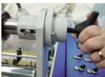
Le mandrin équipé d'un support basculant facilite la mise en place de la bobine.
