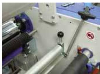
Un dispositif de dévissage réglable pendant la marche garanti un résultat absolument plat en sortie.
