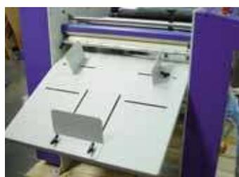
Les feuilles (jusqu'au format A2) sont automatiquement séparées en sortie grâce au dispositif réglable.
