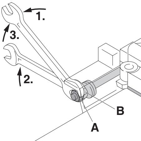
**IT** La lama è dotata di un **dispositivo di frizione** che ne impedisce la discesa involontaria. In caso si verifichino problemi di questo tipo, la frizione può essere regolata seguendo le istruzioni riportate qui di seguito.
