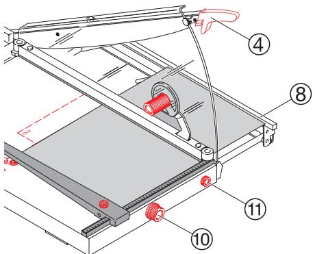
**IT** La carta può essere posizionata anche a filo con la battuta anteriore dotata di dispositivo per rifili millimetrici (8). La manopola graduata (11) consente di determinare con precisione la misura di taglio desiderata, può essere fissata tramite la vite di regolazione per eseguire tagli multipli. I rifili millimetrici (meno di 10 mm) sono possibili grazie allo spostamento automatico della squadra di battuta anteriore durante il taglio.
