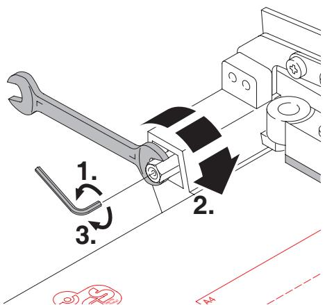
**SV** Maskinen har en **justerskruv** i fästet för kniven. Denna gör att kniven stannar i upprest läge, kan justeras enligt nedan.
