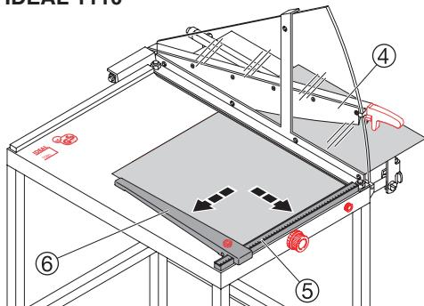
**DE** Messerhebel ④ anheben und Papier von links einlegen. Rückanschlag ⑥ und Seitenanschlag ⑤ ermöglichen eine präzise Papieranlage.
