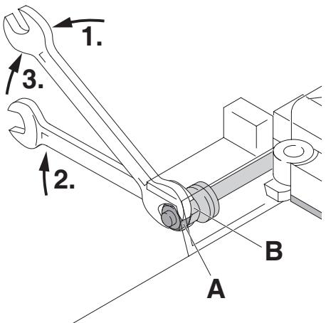
**FR** La machine est équipée d'un **frein** sur le levier de coupe, qui l'empêche de s'abaisser de lui-même dans toute position. Si le cas se produisait, le frein doit être réglé de la manière suivante:
