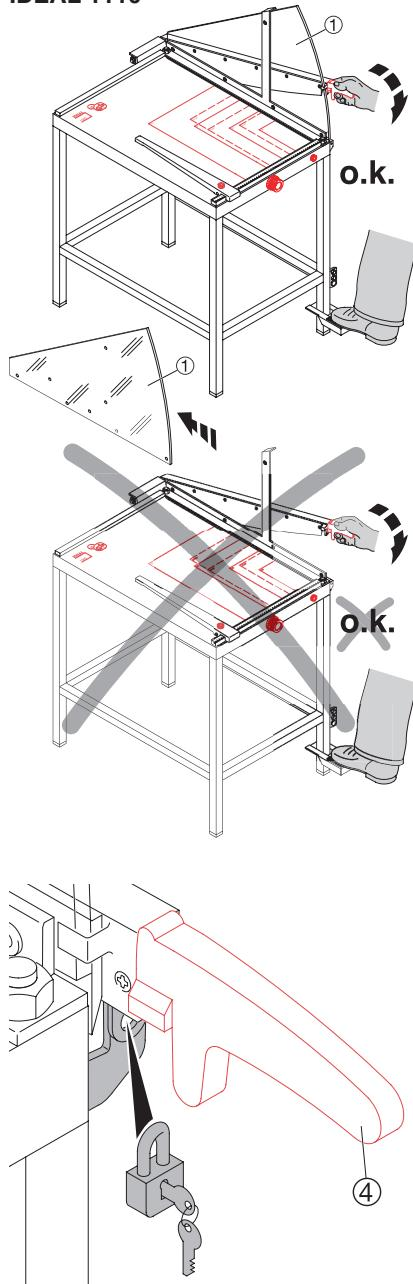
**DE** Bei allen Maschinentypen darf der Messerschutz ① nicht abgenommen werden und muß jederzeit funktionsfähig sein. Die Modelle IDEAL 1080, und IDEAL 1110 sind mit einer Messerverschlußvorrichtung ausgestattet. Bei Bedarf kann der Messerhebel ④ mit dem mitgelieferten Schloß gesichert werden, um Mißbrauch zu verhindern.
