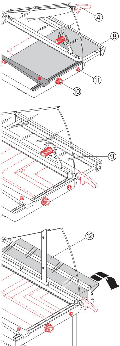
**DE** Das Papier kann auch am Vorderanschlag mit Schmalschnitt-Einrichtung ⑧ angelegt werden. Das gewünschte Maß läßt sich am Skalendrehknopf ⑩ einstellen und kann bei Wiederholungsschnitten mit der Arretierschraube ⑪ fixiert werden. Auch Schmalschnitte (kleiner 10 mm) sind möglich, da der Vorderanschlag bei Schnittausführung automatisch weggklappt.
