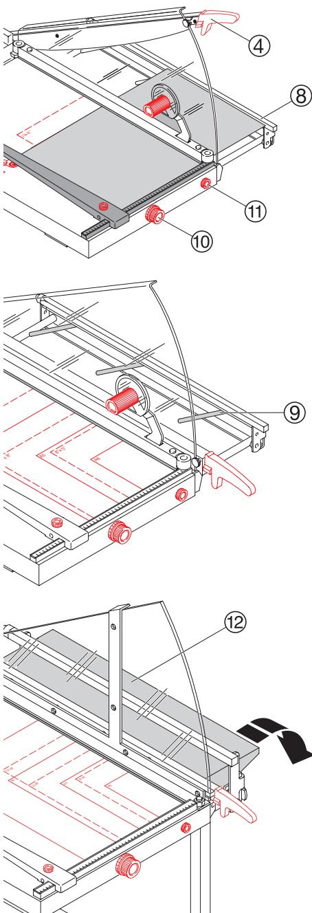
**FR** Le papier peut également être positionné contre le dispositif de coupe de bandes étroites ⑧ situé sur la butée avant. La cote désirée se règle à l'aide du bouton moleté gradué ⑩, et peut être verrouillée pour des coupes répétitives à l'aide de la vis de blocage ⑪. Lors de la coupe de bandes étroites (inférieures à 10 mm de largeur) la butée avant s'effacera automatiquement.
