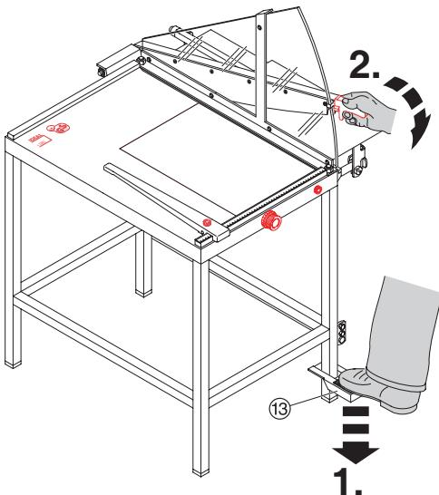
**DE** Dann das Papier mit der Papierpressung ② beziehungsweise mit der Fußpressung ⑬ (IDEAL 1080, IDEAL 1110) pressen und Schnitt ausführen.
