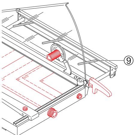
**ES** Las medidas de corte también pueden ser determinadas utilizando la escuadra frontal con el dispositivo de corte estrecho (8). La medida deseada puede ser exactamente establecida con el tornillo calibrado (11) y puede ser fijado con el tornillo de ajuste (10) para poder repetir los cortes. Se pueden realizar cortes estrechos (inferiores a 10 mm) ya que la escuadra frontal es sujetada automáticamente durante el corte.
